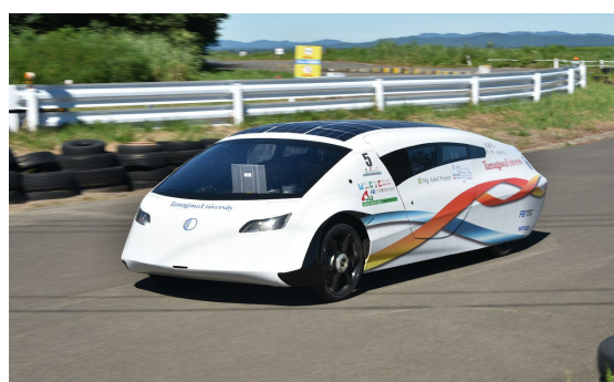
<写真 14> メカニカル充電方式マグネシウム空気電池 (S-Mg concept 号)
