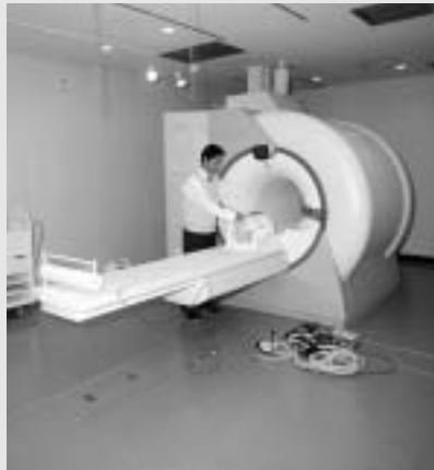
1階にある「磁気共鳴画像装置（MRI）」。磁気共鳴現象を利用して、外科的な手段を用いずに脳のどの部分が活動しているかを画像化することができる
