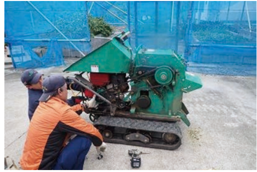
チップーシュレッダーの修理
