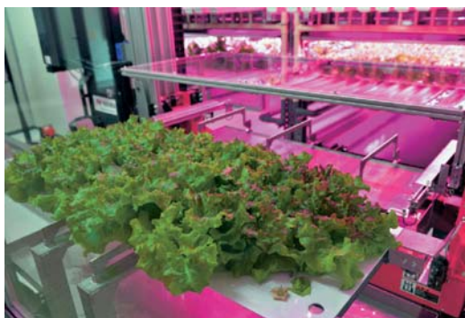
図6 栽培装置から野菜を取り出す収穫システム
