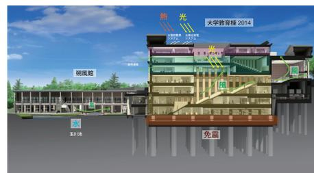
**光**・・・「トップライト」による自然光の利用を図り、照明の電力消費を低減します。「太陽光発電システム」により、教育学術情報図書館のブックサロンは、ゼロエネルギー化を目指します。
