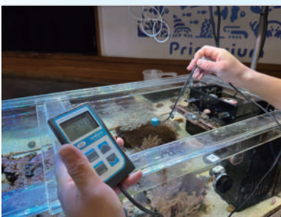
水深によってサンゴの増殖にどのような影響が出るかを、光量を調整することで実験した様子。
